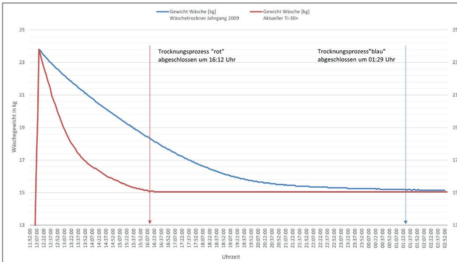
Während der ganze Trocknungsprozess mit einem neuen, energieeffizienten Gerät (LUNOR Ti-30+) gerade mal 5 Stunden dauert, benötigt ein alter Raumluft-Wäschetrockner technologiebedingt volle
